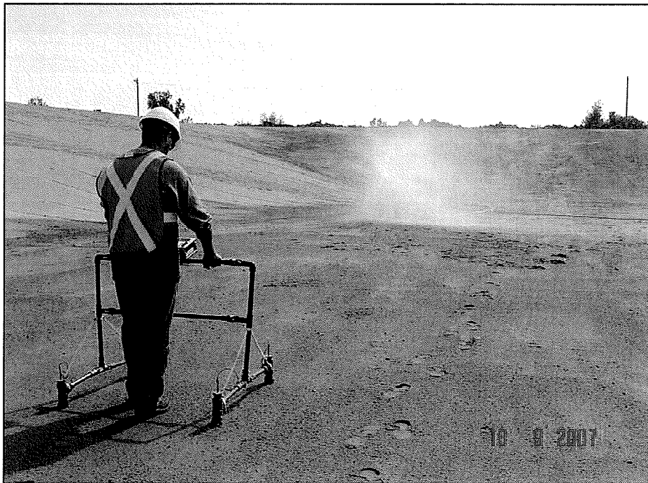
Photo 6 : Structure pour prospection au dipôle
