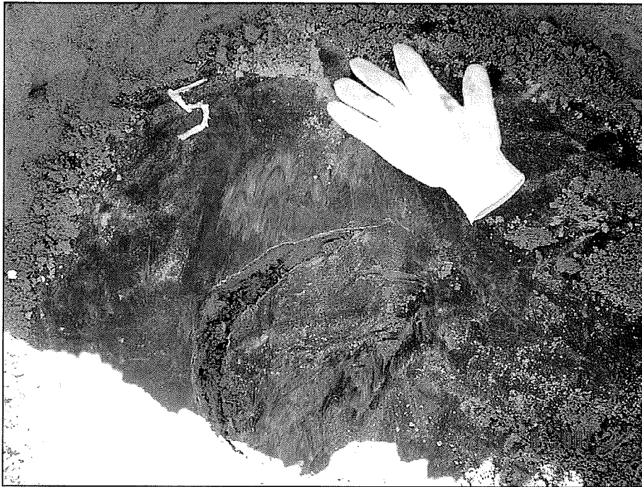
Photo 11 : Perforation F5 détectée au dipôle
