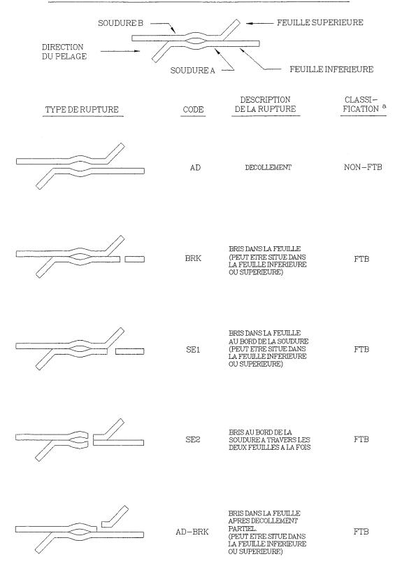
$<sup>^{\</sup>mbox{\scriptsize a}}$  FTB="FILM-TEAR BOND." (RUPTURE DANS LA FEUILLE)
