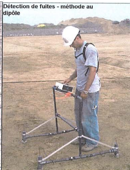
Détection de fuites au dipôle sur 1 re couche de sable – (17 juillet 2006)
