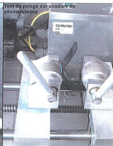
Test de pelage in-situ sur soudure
