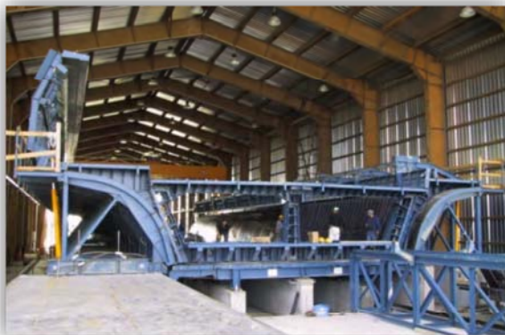
Photographie 7-12 – Ligne de préfabrication de voussoirs
