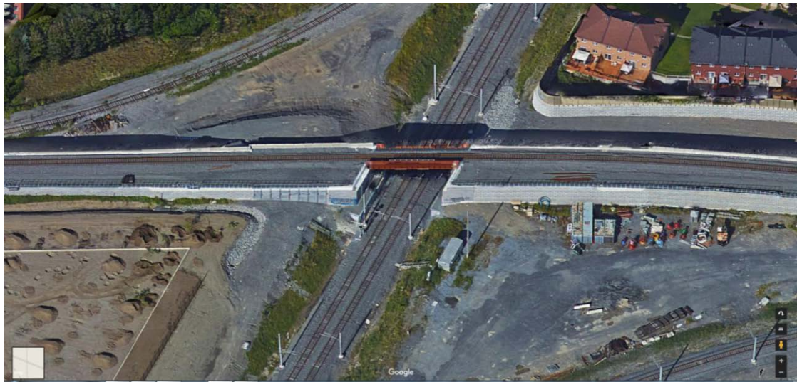
Figure 5-12 : Exemple d'étagement de voie ferrée (1)
