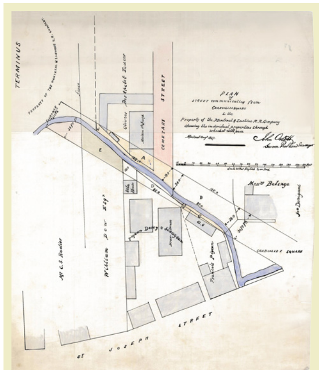
Plan de John Ostell : canalisation d'un tronçon du ruisseau Prud'homme pour l'ouverture de la rue Albert
