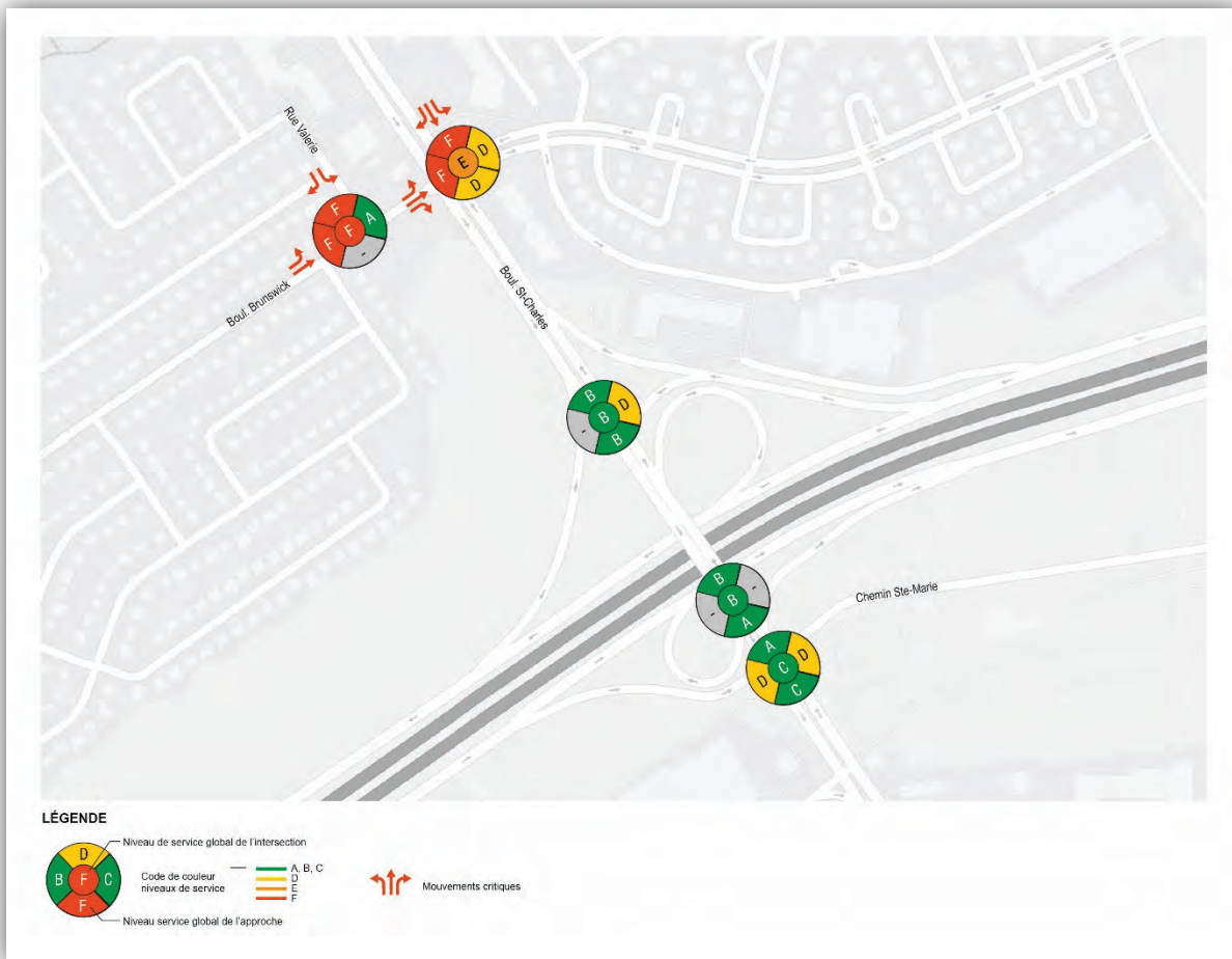
Figure 2-4 — Conditions actuelles de circulation à l'heure de pointe du matin (7 h 45 à 8 h 45)
