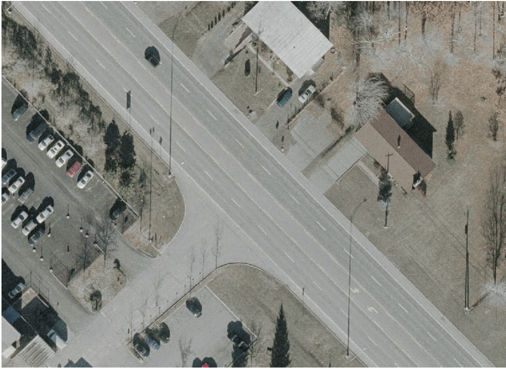
Photo 5 Option 4 – Route à cinq voies contiguës avec une voie réservée pour les virages à gauche
