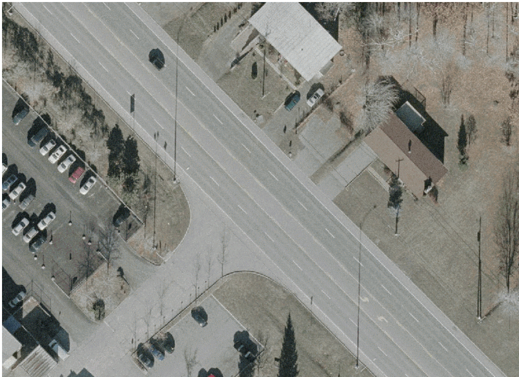
Photo 6.2.5 Option 4 – Route à cinq voies contiguës avec une voie réservée pour les virages à gauche
