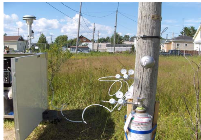
OSISKO Malartic: Échantillonnage de l'air ambiant Station no.1 (à proximité de la mine) - Vues des équipements et des gaz d'étalonnage
