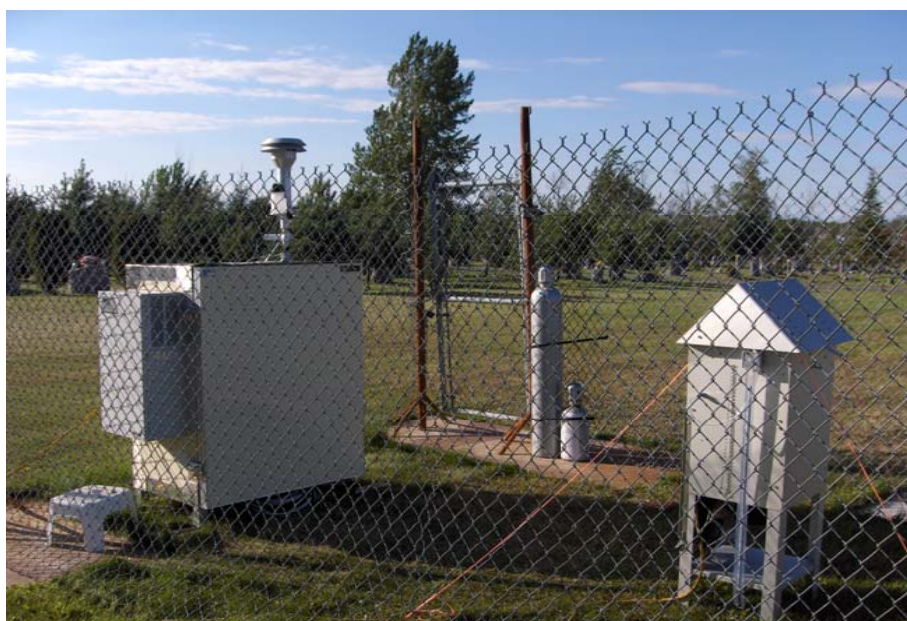
OSISKO Malartic: Échantillonnage de l'air ambiant Station no.2 (zone de relocalisation) - Vue avec tous les équipements (TEOM + Hi-Vol)
