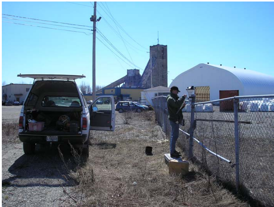
Photo 16 Pluviomètre installé à la station M1, à proximité des bureaux d'OSISKO Exploration Ltée.
