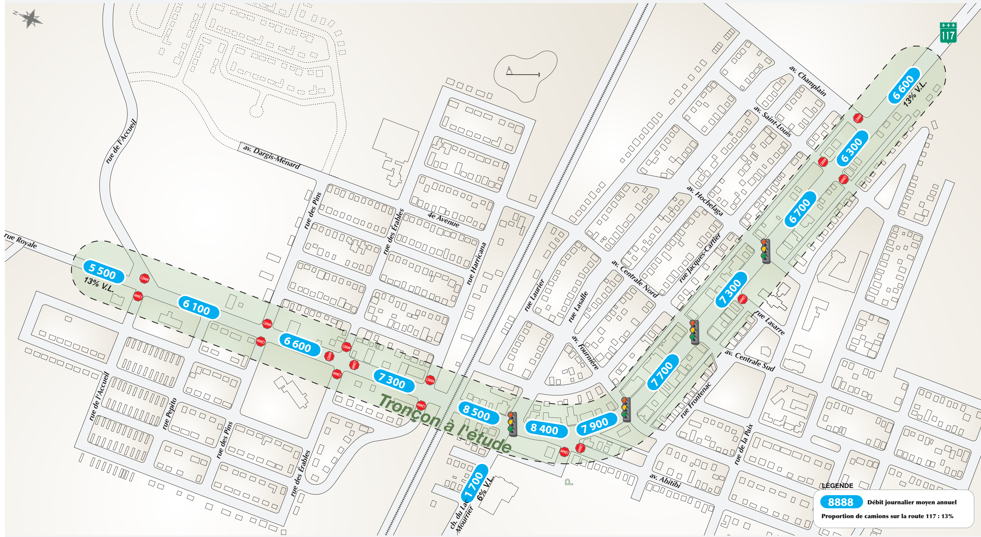
Figure 3 Zone d'étude - Situation actuelle Débits et gestion de la circulation
