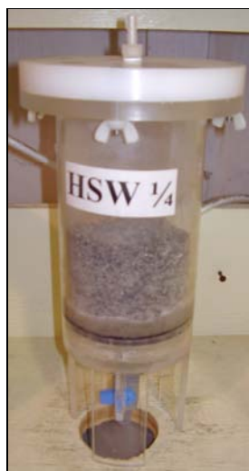
Figure 1 : Cellule d'humidité type pour les échantillons représentant les stériles miniers
