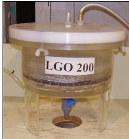
Figure 2 : Cellule d'humidité type pour les échantillons représentant les rejets de concentrateur
