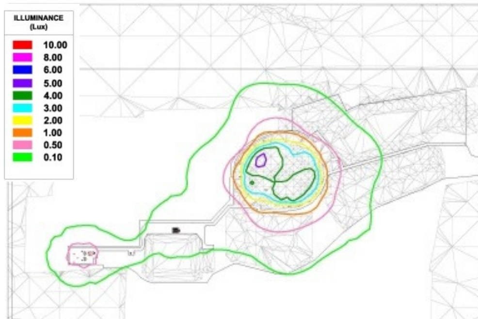
Figure 6 Isolignes mesurées à 100 m au-dessus du sol des futures installations en hiver
