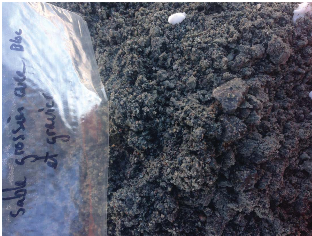
Photographie 20 : Échantillon de sable et gravier recoupé par le puits d'essai PE-01-15
