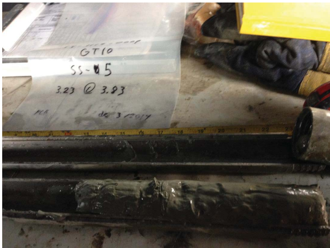
Photographie 16 : Échantillonnage des sédiments fins dans un forage
