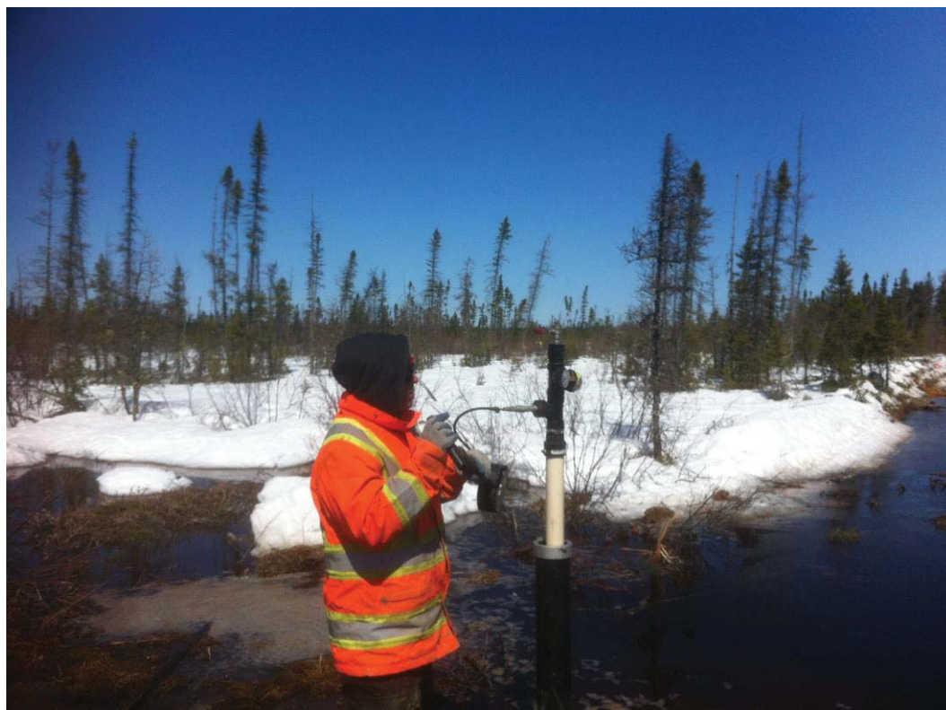
Photographie 12 : Réalisation d'un essai à l'aide d'un perméamètre pneumatique
