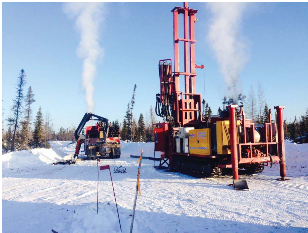
Photographie 18 : récupération d'un échantillon en vrac dans un forage destructif
