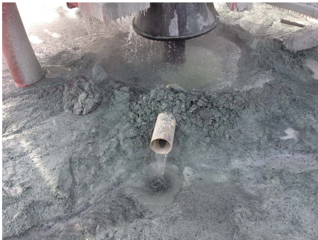
Photographie 20 : Échantillon de sable et gravier recoupé par le puits d'essai PE-01-15
