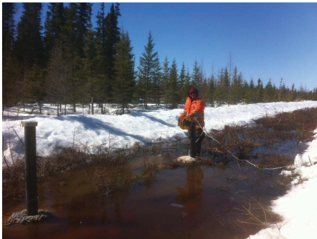
Photographie 14 : Mesure du niveau d'eau dans un puits d'observation
