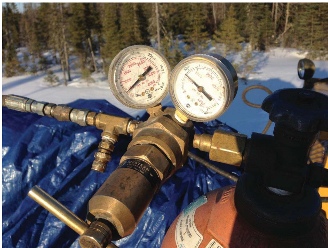
Photographie 26 : Gonflage des obturateurs à l'azote
