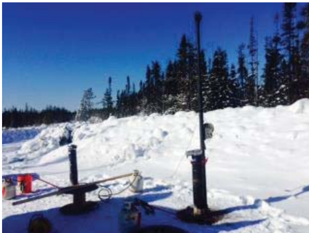
Photographie 24 : Insertion d'un dispositif d'obturateurs dans un forage
