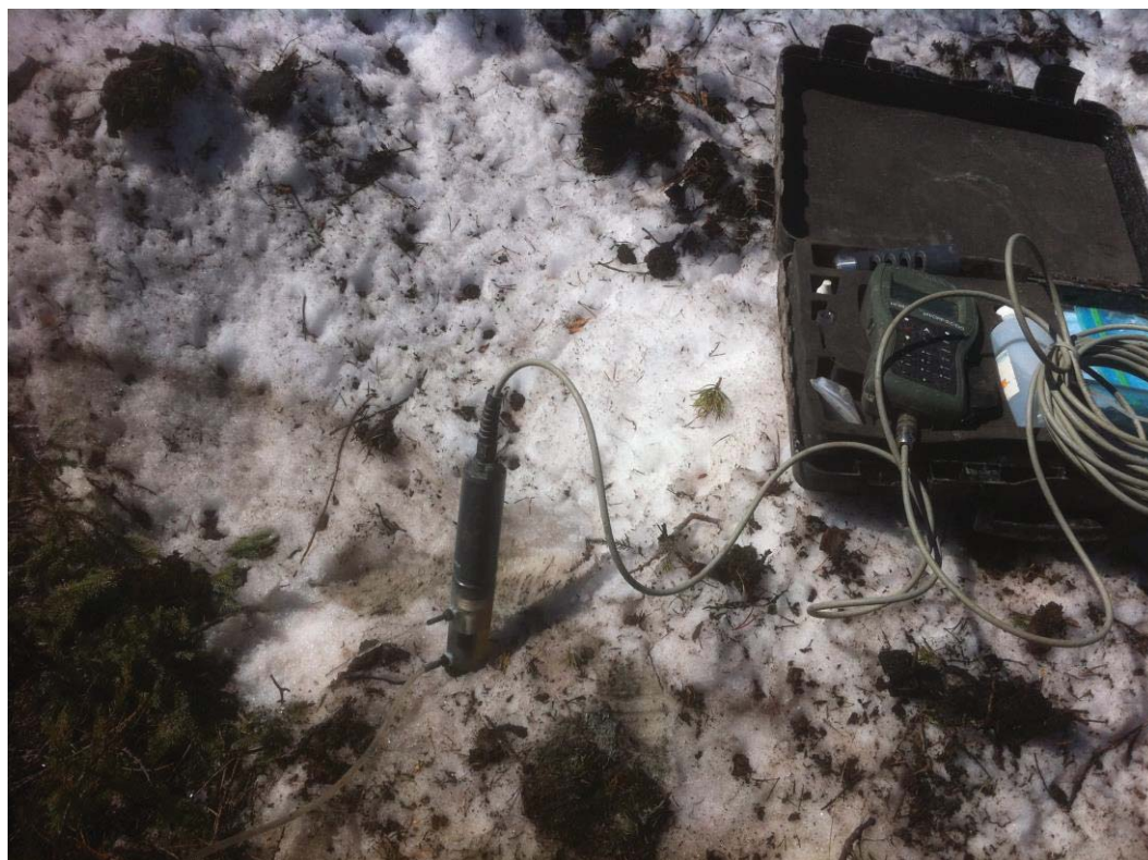
Photographie 12 : Réalisation d'un essai à l'aide d'un perméamètre pneumatique
