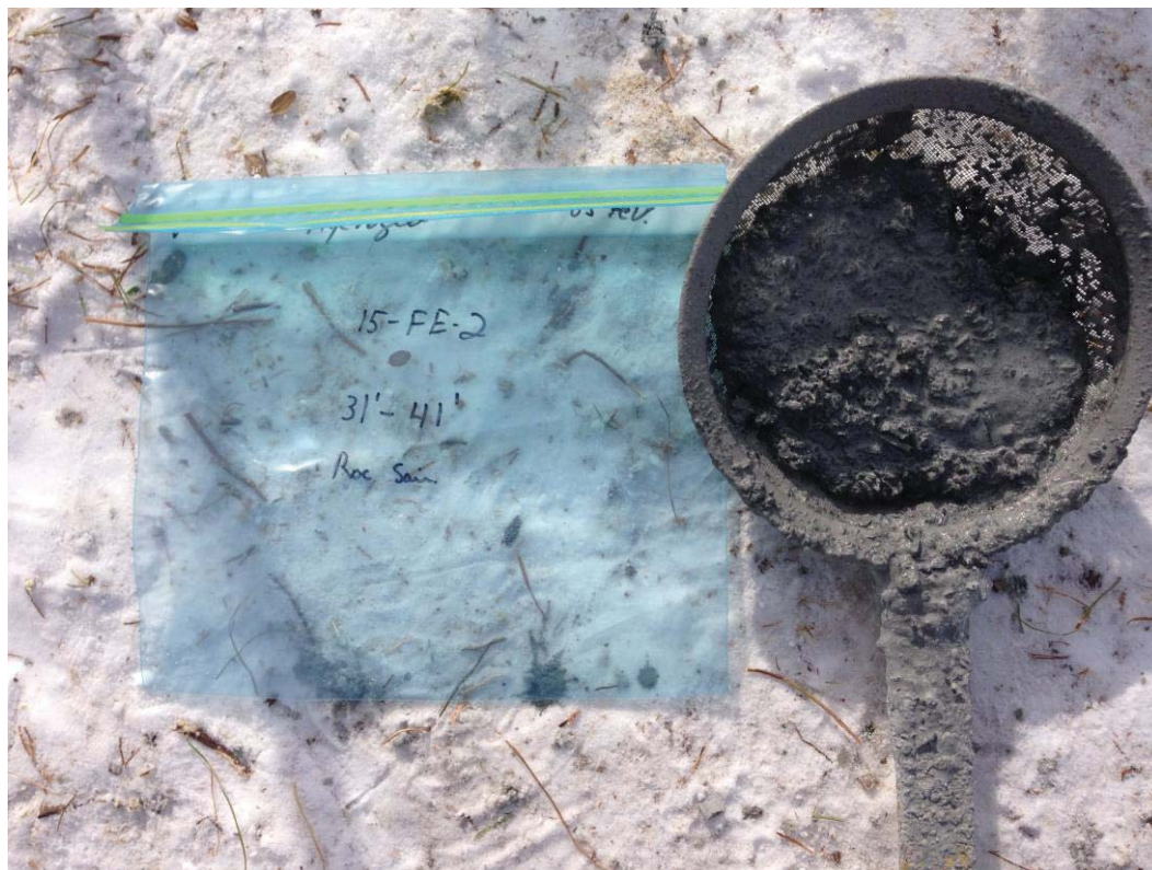
Photographie 18 : récupération d'un échantillon en vrac dans un forage destructif
