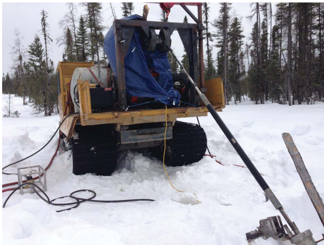
Photographie 24 : Insertion d'un dispositif d'obturateurs dans un forage
