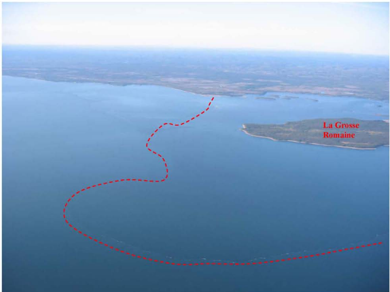
PHOTO 4.2.3 — Vue du panache d'eau brune sortant de la zone de l'embouchure de la Romaine (30 septembre 2004) durant le jusant (débit de la rivière : 160 \text{ m}^3/\text{s} ) ; la ligne pointillée indique l'emplacement du front
