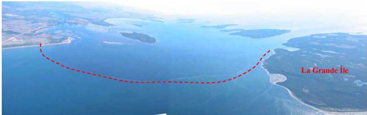
PHOTO 4.2.2 — Vue du panache d'eau brune sortant de la zone de l'embouchure de la Romaine (20 octobre 2004) à la fin du jusant (débit de la rivière : 417 \text{ m}^3/\text{s} ) ; la ligne pointillée indique l'emplacement du front
