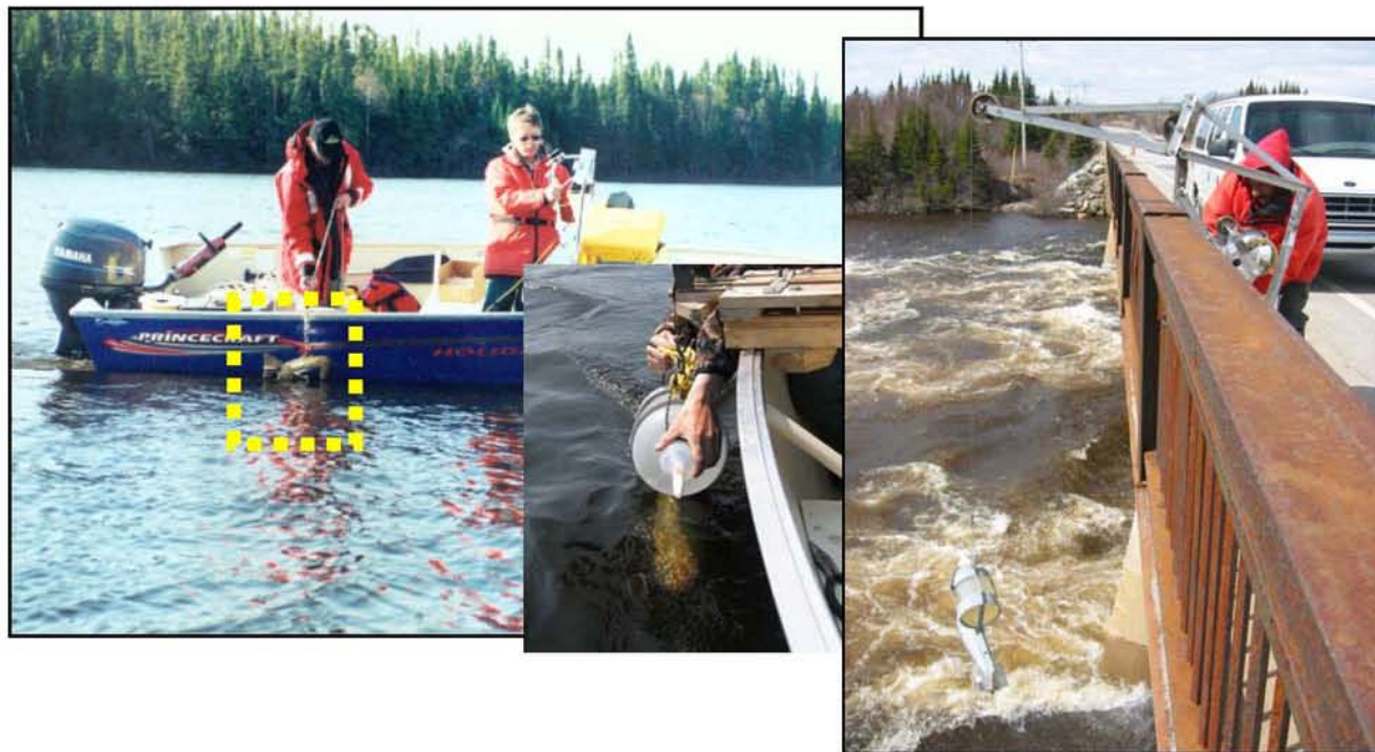
FIGURE 3.1.4 — Échantillonneurs utilisés pour l'échantillonnage de la charge en suspension et de la charge de fond sur la rivière Romaine, printemps 2003 et 2004
