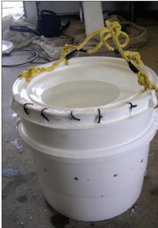
PHOTO 4 Trappes à sédiments pour la période d'échantillonnage du printemps.
