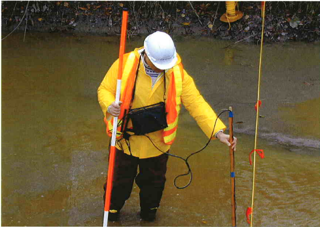
11. Mesures de vitesses en utilisant l'appareil de mesure électromagnétique portable - Point 2 / Electromagnetic portable velocimeter measurements - Point 2
