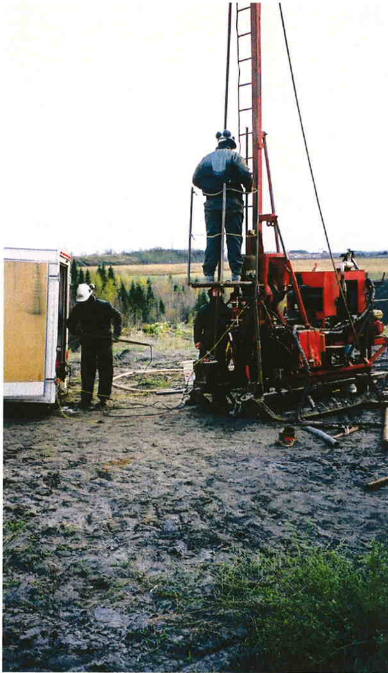
3. Sondage au piézocône PZC-03-10 / Piezocone sounding PZC-03-10
