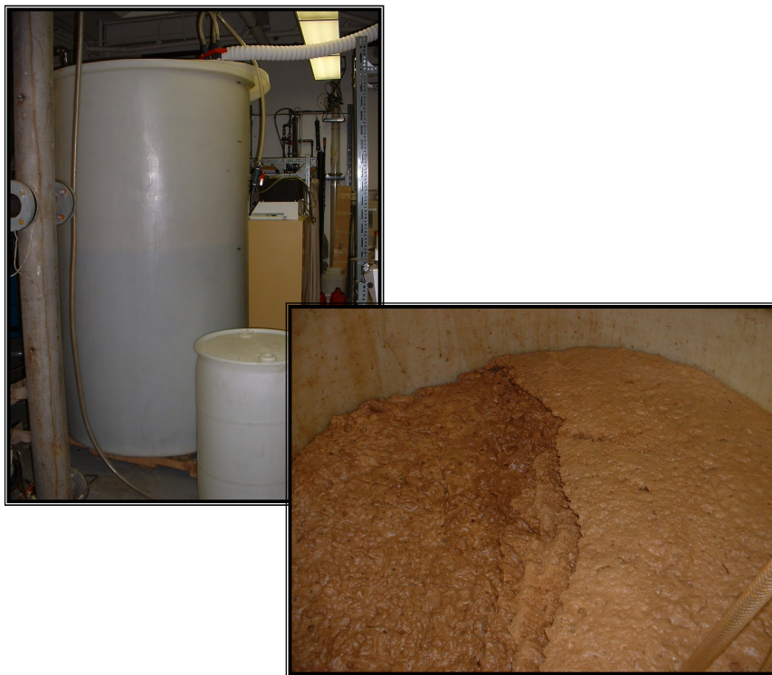
Figure 23. Problèmes de moussage au démarrage de l'aération de la cuve de 2400 L
