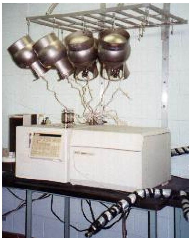
Figure 8 Vue d'ensemble d'un CPG/SM
