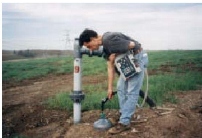
Figure 5 Mesure de COVTME près d'un puits de captage à l'aide d'un analyseur portable
