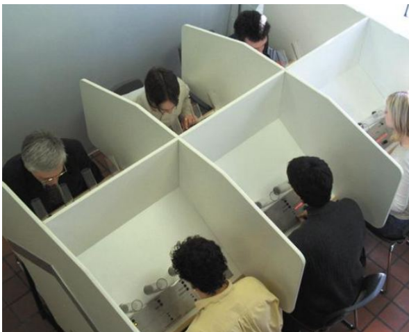
Figure 6 Olfactomètre à dilution dynamique : salle du jury
