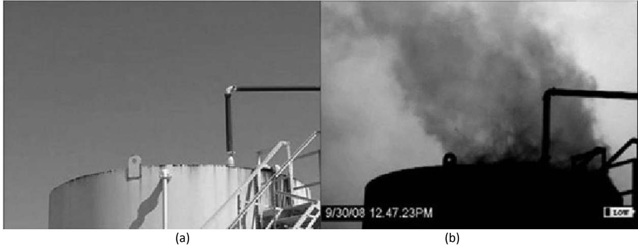
FIGURE 2 89 : (a) Réservoir de condensat vu à l'œil nu (b) Même réservoir vu avec une caméra thermique laissant voir la chaleur d'un gaz qui s'échappe. Celui-ci serait toxique selon l'étude présentée dans le documentaire. 90
