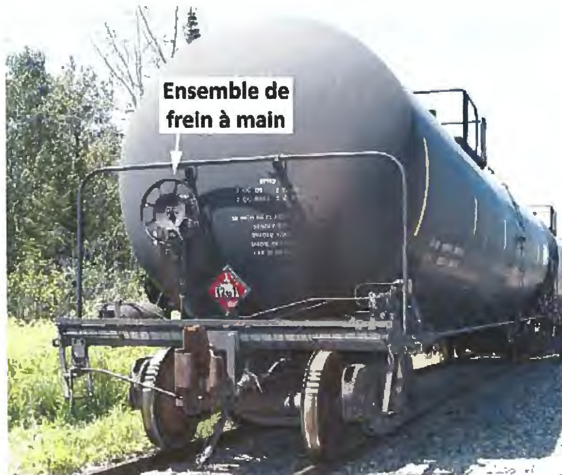
Photo 9. Timonerie et volant du frein à main à l'extrémité B d'un wagon-citerne
