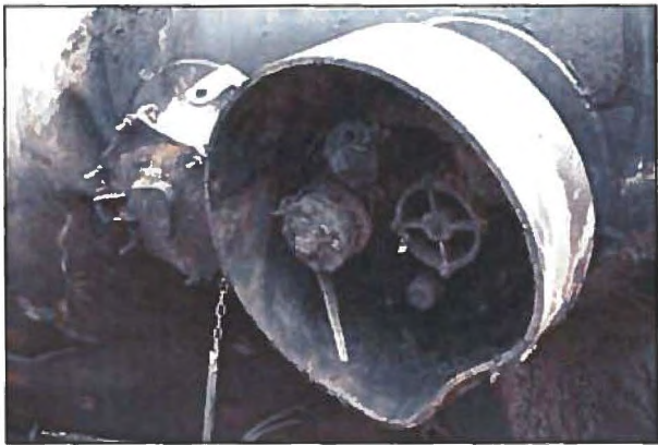
Photo 21. Enceinte protectrice conçue pour assurer la protection des discontinuités des raccords supérieurs de wagon-citerne (couvercle enlevé)
