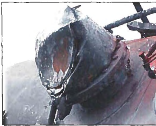
Photo 22. Enceinte à charnières installée sur les raccords supérieurs de wagon-citerne
