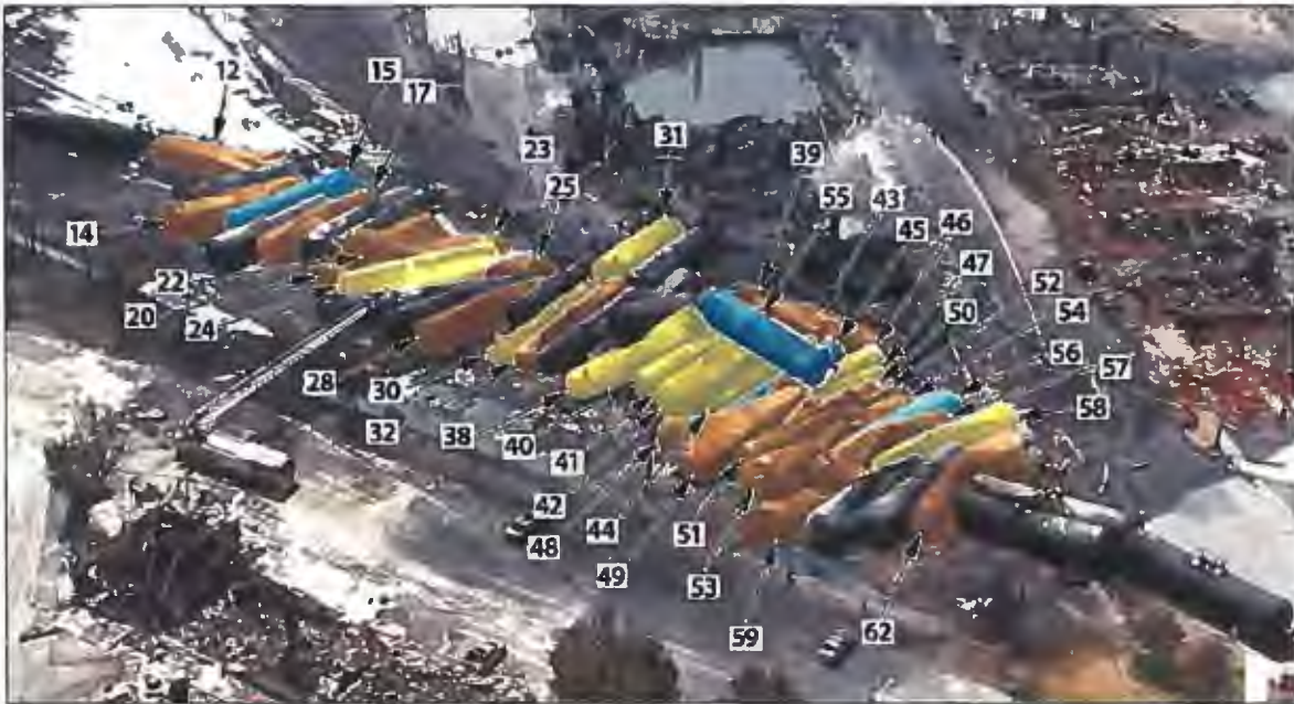
Photo 19. Wagens-citernes dont la coque a été perforée (la couleur indique la grosseur relative des perforations : orange=grosse perforation, jaune=perforation moyenne, bleu=petite perforation). La grosseur relative des perforations est indiquée à l'annexe B.
