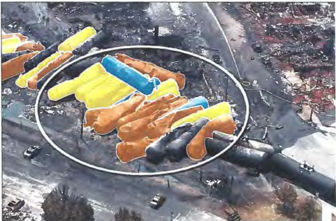
Photo 30. Concentration des perforations de grande dimension (orange) et de moyenne dimension (jaune) vers la queue du déraillement
