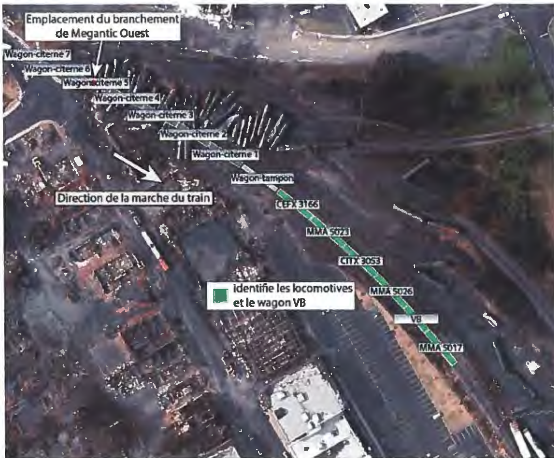
Photo 29. Endroit où se trouvait le train lorsque la pression dans la conduite générale a chuté à 0 lb/po 2 (source : AeroPhoto et données du consignateur d'événements de locomotive)
