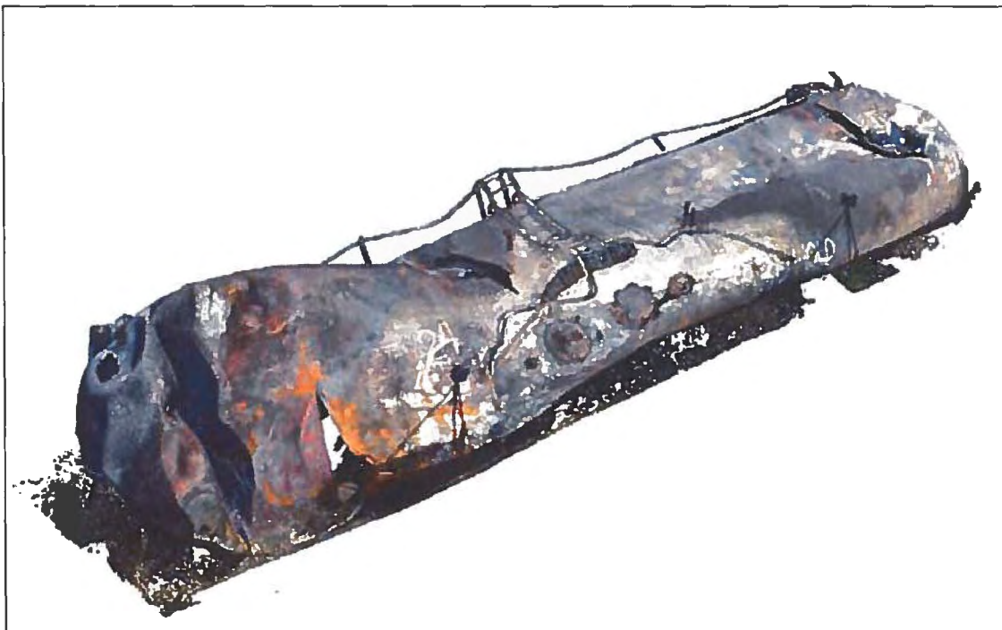
Photo 16. Balayage laser en 3 dimensions d'une citerne très déformée
