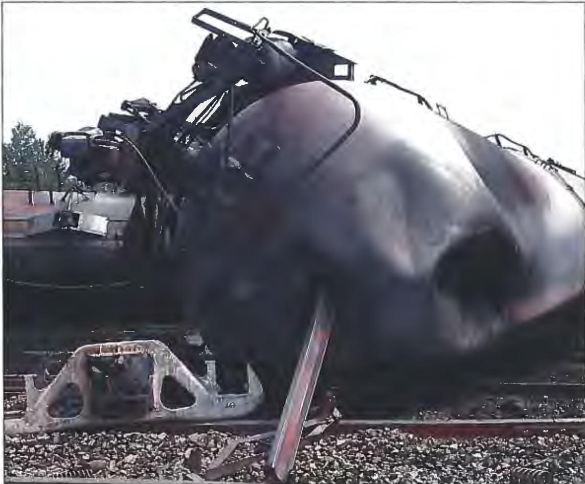
Photo 20. Perforation de la tête en raison d'un impact avec un rail
