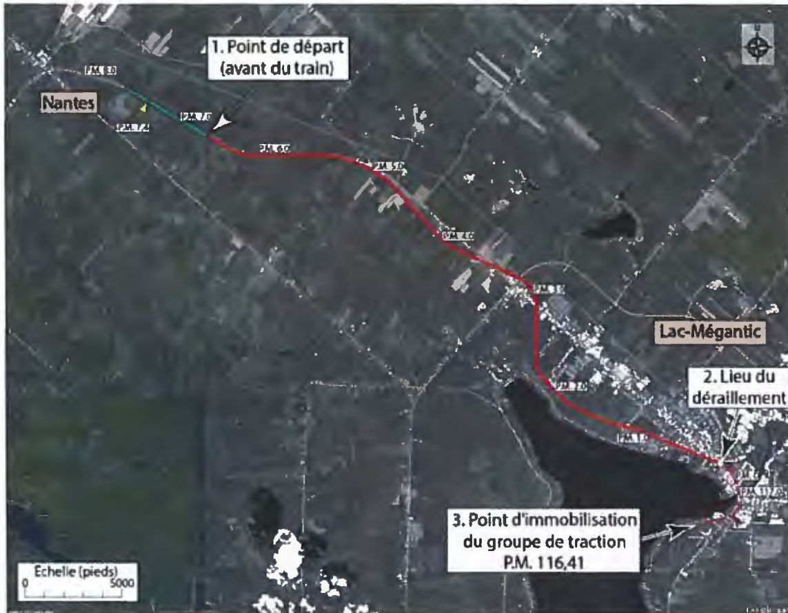
Figure 3. Les 3 endroits sur lesquels l'enquête s'est concentrée : Nantes, le centre-ville de Lac-Mégantic et l'endroit où les locomotives ont arrêté leur course (point milliaire 116,41 de la subdivision Moosehead) (source : Google Earth, avec annotations du BST)
