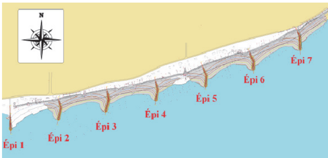
Figure 4-2 : Vue de l'ensemble des épis proposés et géométrie de la recharge de plage
