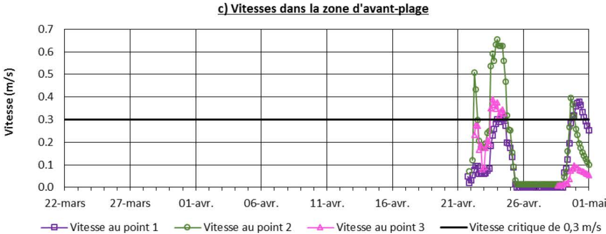
Figure 5.11: Canal de largeur 10 m avec radier à 98,5 m - Niveaux et vitesses pour la crue de 2008
