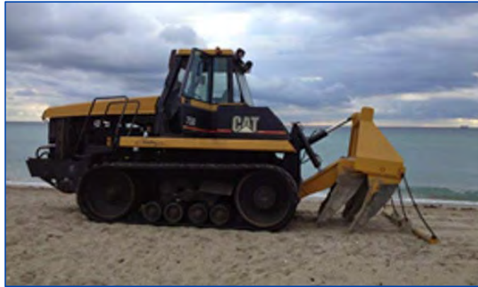
Figure 3-10. Exemple de machinerie de décompactage (source : Santiva Chronicle [www.santivachronicle.com])
