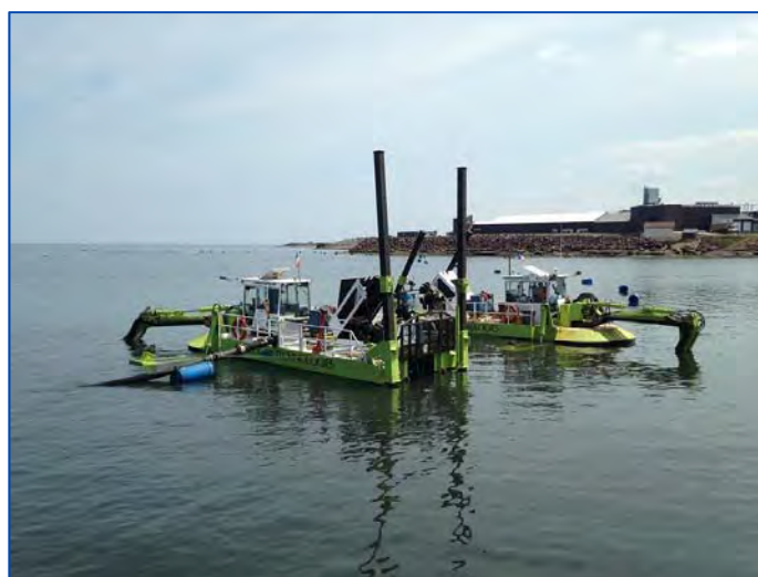
Figure 3-9. Exemple de petit dragage à succion et à pelle hydraulique de type grenouille, avec système de conduites (source : ECO Technologies [www.ecotec.ca])
