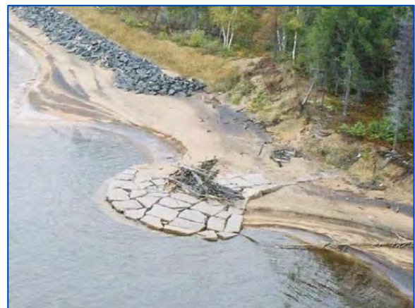
Figure 3-14. Exemple d'un épi en éventail aménagé au lac Saint-Jean – secteur Parc national de la Pointe-Taillon (ALCAN 2007)
