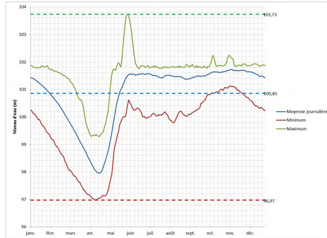
Figure 5-11. Niveau moyen journalier du lac Saint-Jean et enveloppe des minimums et maximums pour la période 1927-1942
