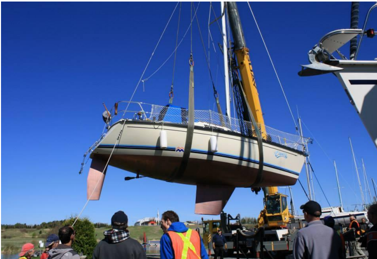
Photo 10 : Opération grutage pour la mise à l'Eau
