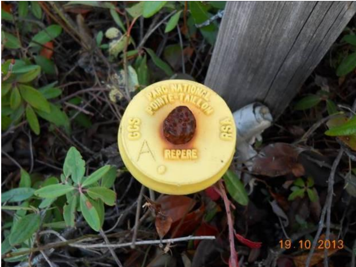
Figure 5 – Borne utilisée pour le suivi de l'érosion des berges au parc national de la Pointe-Taillon
