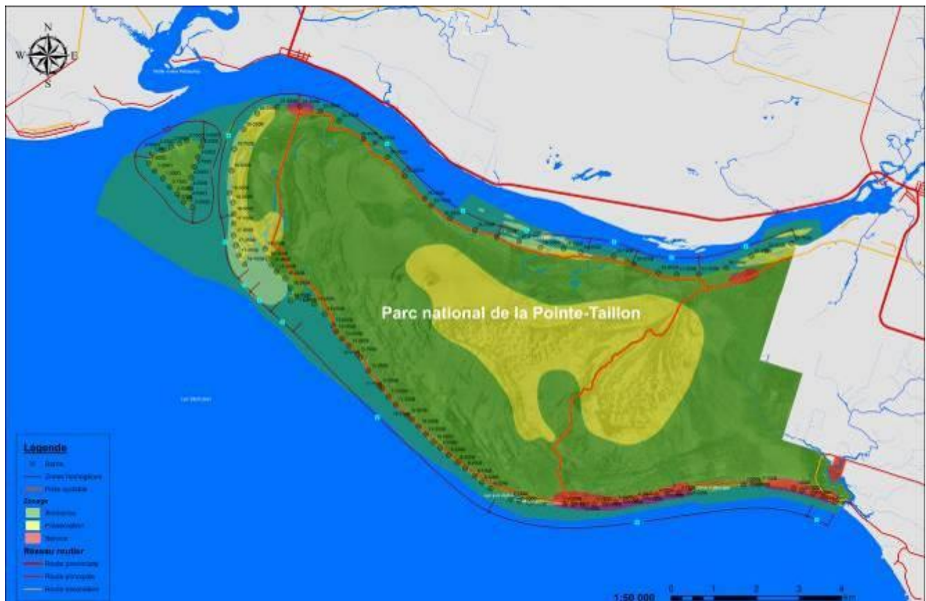
Figure 4 – Réseau de stations pour le suivi de l'érosion des berges au parc national de la Pointe-Taillon.
