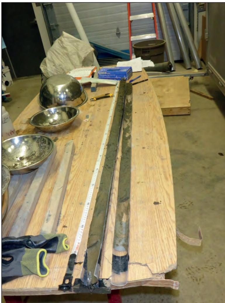
Figure 2-2 Ouverture des carottes et sous-échantillonnage en laboratoire
