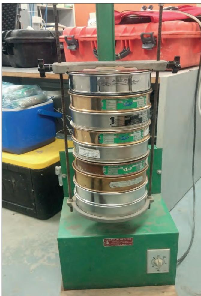
Figure 2-3 Tamisage des échantillons
