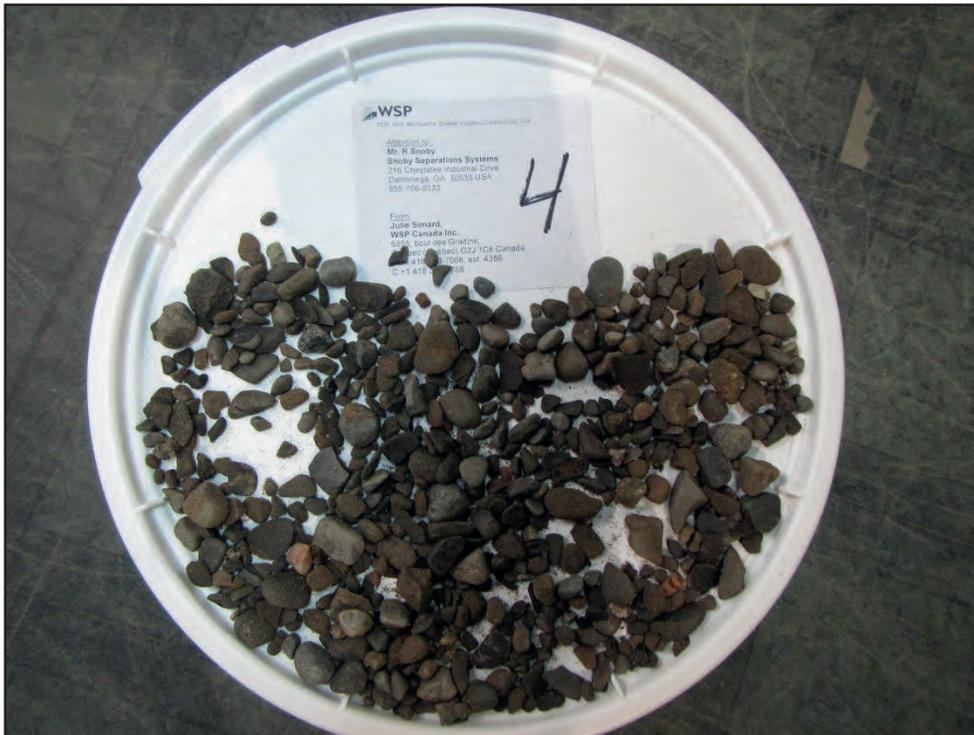
Photo 4 Échantillon n° 4 de matériel de 5-20 mm du banc Aly Blackburn.
