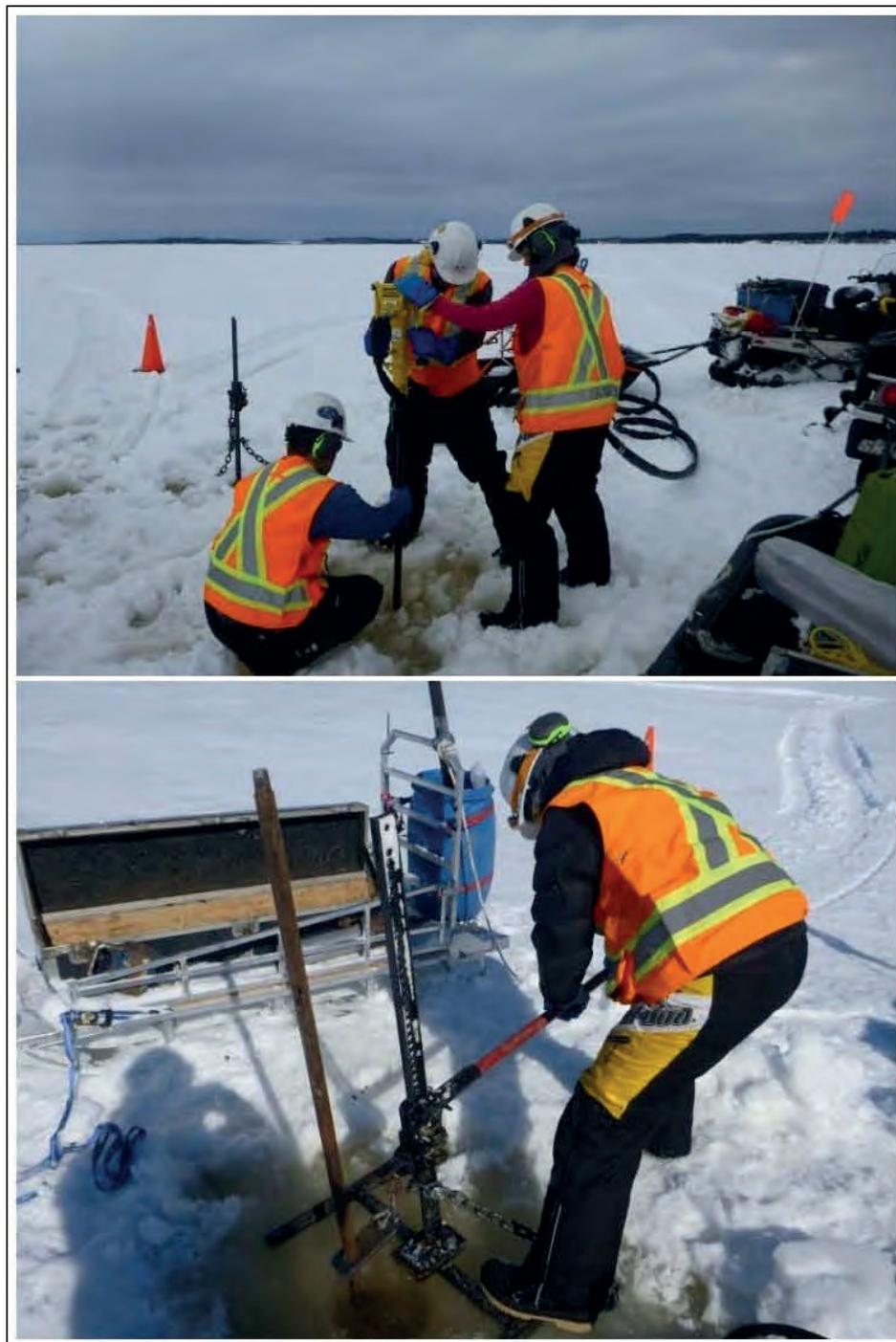
**Figure 2-1** Carottier de marque Géoprobe monté d'un marteau hydraulique et extraction de la carotte à l'aide du levier manuel
