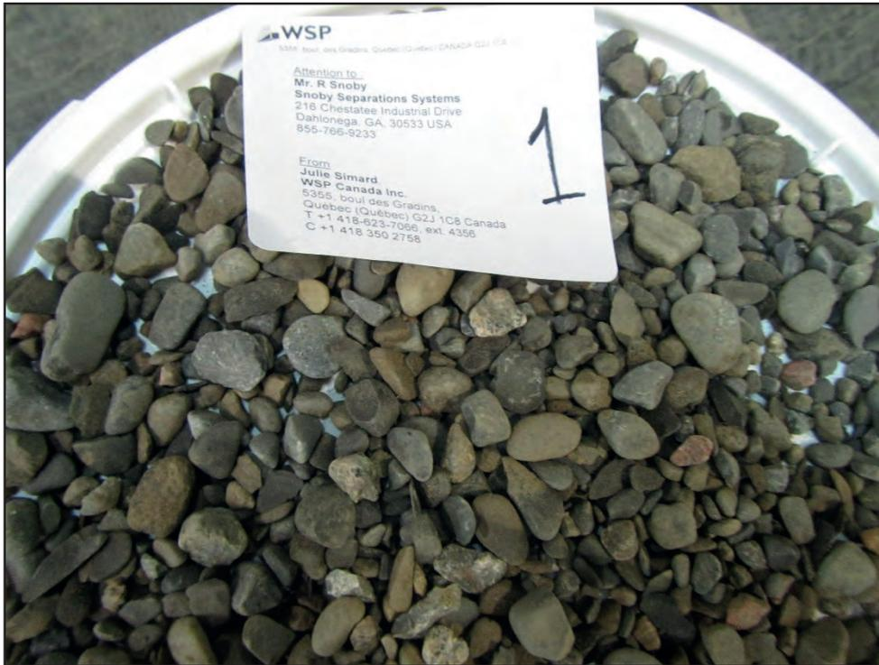
Photo 1 Échantillon n° 1 de matériel de 5-20 mm du banc Aly Blackburn.
