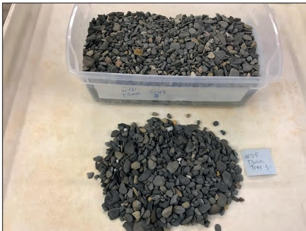
Photo 17 Matériel de la couche n° 5 provenant du test de gravité spécifique.
