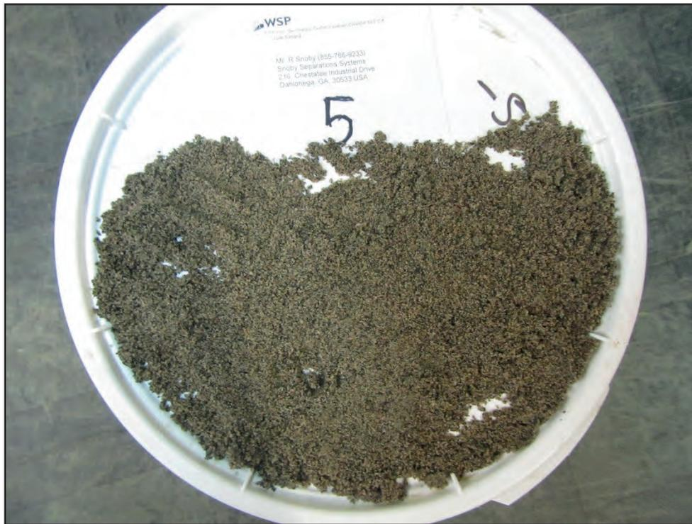
Photo 5 Échantillon n° 5 de matériel de 0-5 mm du banc Aly Blackburn.
