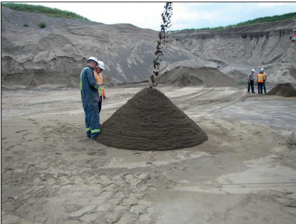
**Photo 3 Matériaux conformes au fuseau granulométrique (0-5 mm) et provenant des matériaux pré-tamisés 0-5 mm**
