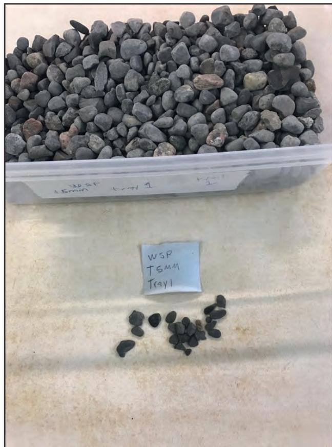
Photo 14 Matériel de la couche n° 1 provenant du test de gravité spécifique.
