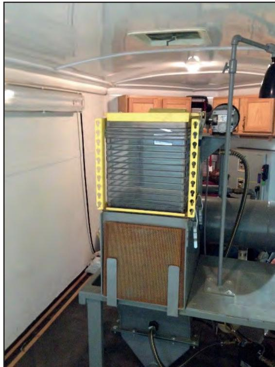
Photo 10 Appareil pour le test de séparation par densité (jig).
