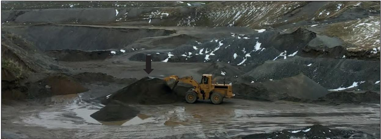
Photo 7 Pile de réserve en gravillons (0-20 mm), banc Aly Blackburn.
