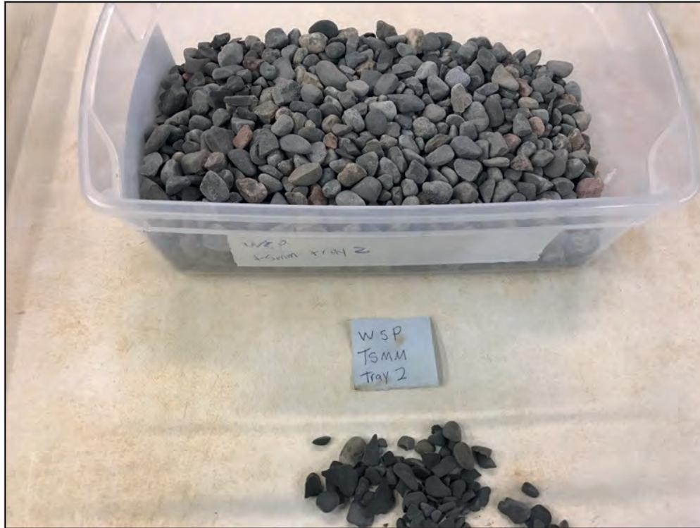
Photo 15 Matériel de la couche n° 2 provenant du test de gravité spécifique.
