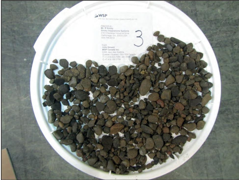
Photo 3 Échantillon n° 3 de matériel de 5-20 mm du banc Aly Blackburn.
