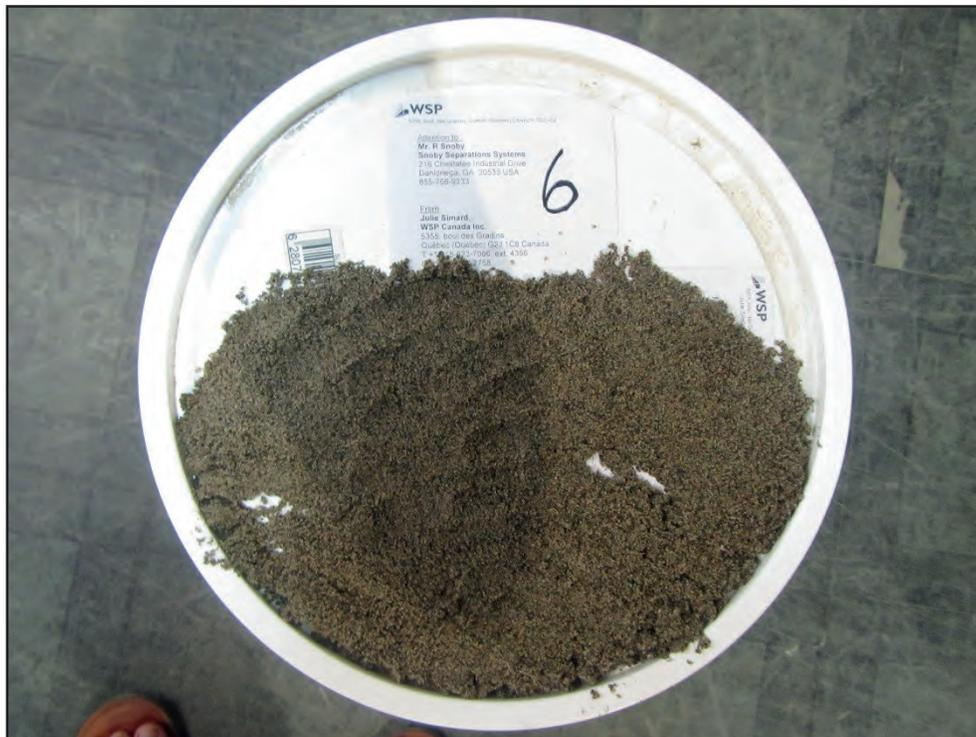
Photo 6 Échantillon n° 6 de matériel de 0-5 mm du banc Aly Blackburn.
