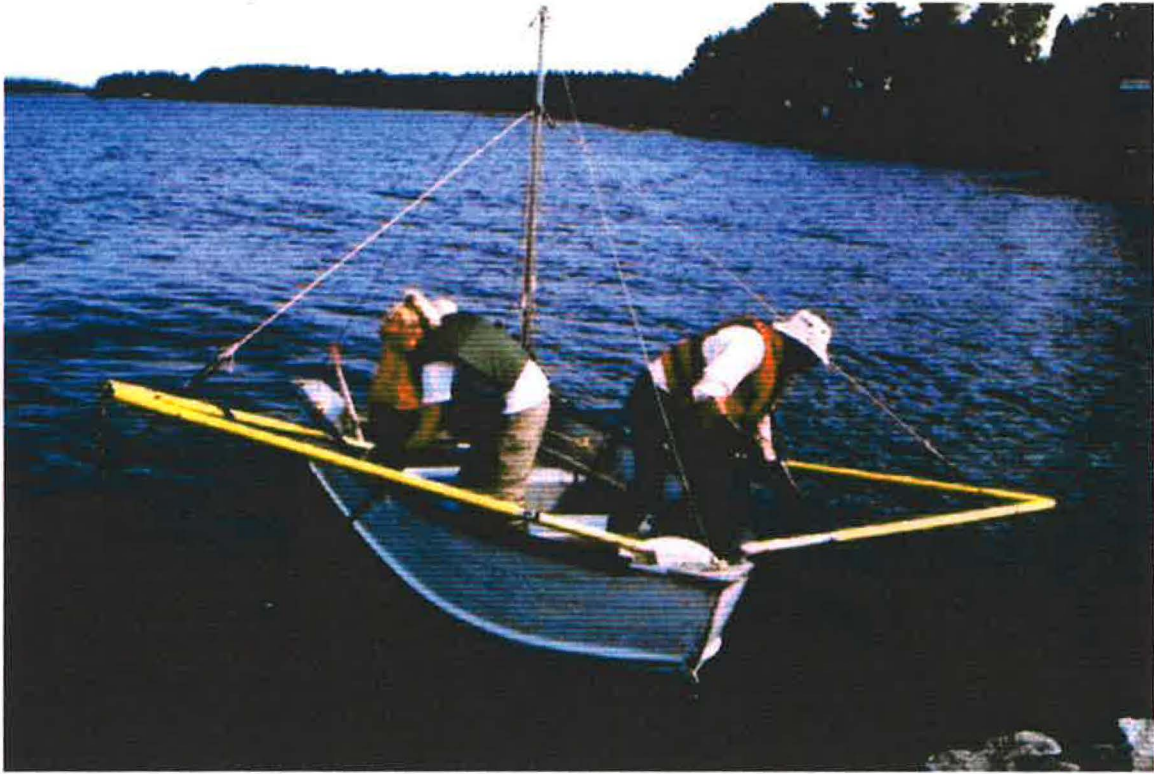
Bateau de pêche à l'électricité utilisé pour l'échantillonnage de la faune ichthyenne.
