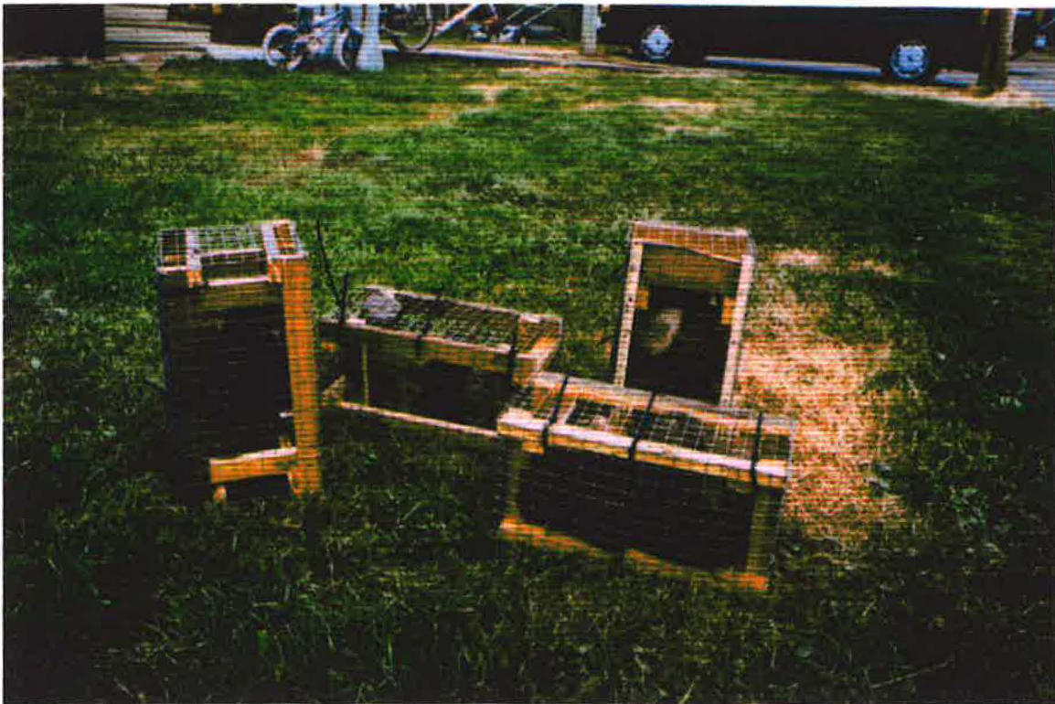
Engins d'échantillonnage utilisés pour vérifier la colonisation par les macro-invertébrés.
