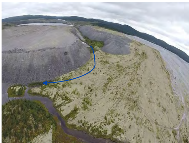
Photo 7. Écoulement souterrain de l'émissaire du lac Jeannine sous le parc à résidus
