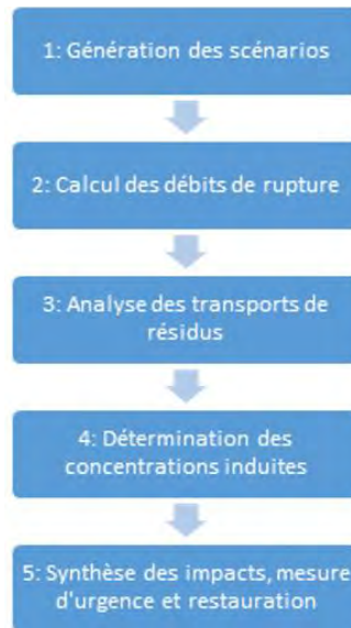
Figure 1 : Principales étapes de l'étude des impacts d'une rupture d'une digue d'un parc à résidus avec transport de résidus [Réf. 11].
