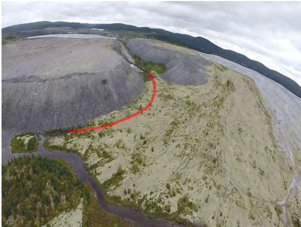
Photo 19. Écoulement souterrain de l'émissaire du lac Jeannine sous le parc à résidus
