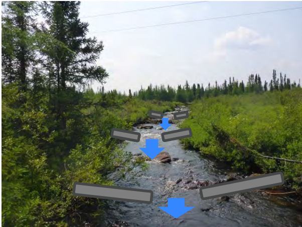
Photo 11. Mise en place de seuils-bassins dans les sections lotiques (segment 2)
