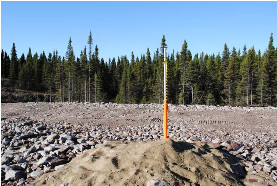
Qu'est-ce que c'est ? Il s'agit d'un piézomètre, un appareil permettant de mesurer les variations de pression et du niveau d'eau dans le sol. Les mesures obtenues permettront de connaître la fin des tassements des sols en place, ce qui assurera la stabilité des ouvrages. On en trouve à plusieurs endroits dans la zone de travaux.
