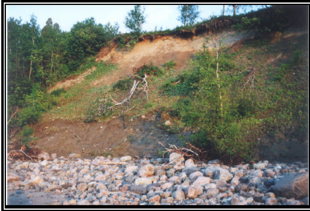
PHOTO 3 : On distingue au sommet de la pente, une section en porte-à-faux. Au centre du cliché, on observe un groupe d'arbre qui ont dégringolé à partir du sommet du talus.
