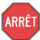
Ce panneau indique aux conducteurs qu'ils doivent immobiliser leur véhicule pendant un moment. On doit l'installer à l'endroit même où il faut s'arrêter et le faire précéder d'un signal avancé d'arrêt (D-10-1).
