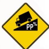
Aux abords des pentes dont l'inclinaison est de 10% ou plus sur une distance d'au moins 120 mètres, on doit installer un panneau D-230-1. Le pourcentage maximal d'inclinaison de la pente y est indiqué en blanc. Lorsque la pente est très longue ou qu'elle comporte des virages qui réduisent la visibilité, on installe plus d'un panneau.
