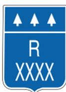
On doit installer le panneau qui indique le numéro d'un chemin à son entrée, à la jonction d'une route régionale ou d'un autre chemin numéroté. Il est toujours placé sur le côté droit de la voie.
