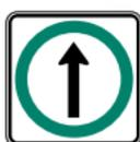
Ces panneaux, qui indiquent aux conducteurs la direction à prendre, doivent être installés à proximité de l'endroit où la manœuvre doit être effectuée. Le panneau P-110-1 signale l'obligation d'aller tout droit; le panneau P-110-2-G, l'obligation de tourner à gauche et le panneau P-110-2-D, celle de tourner à droite.
