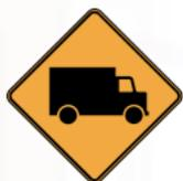
Ce panneau est placé environ 250 m avant une sortie temporaire de camions (carrière, usine de transformation, etc.). On doit l'enlever dès que la traverse n'est plus utilisée. Si cette dernière devient permanente, on devra la signaler comme les autres intersections.
