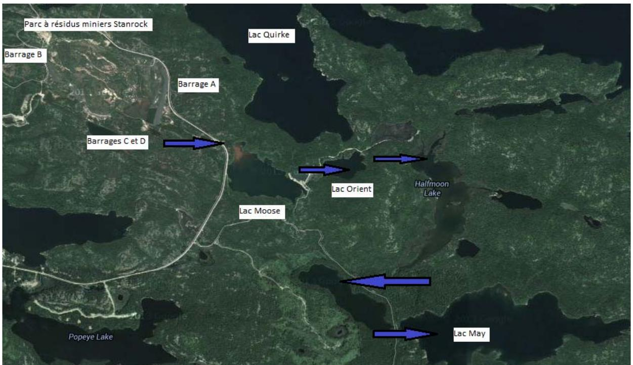
Figure A-3. Parc à résidus minier Stanrock. Les flèches bleues indiquent la direction de l'écoulement des eaux de surface.
