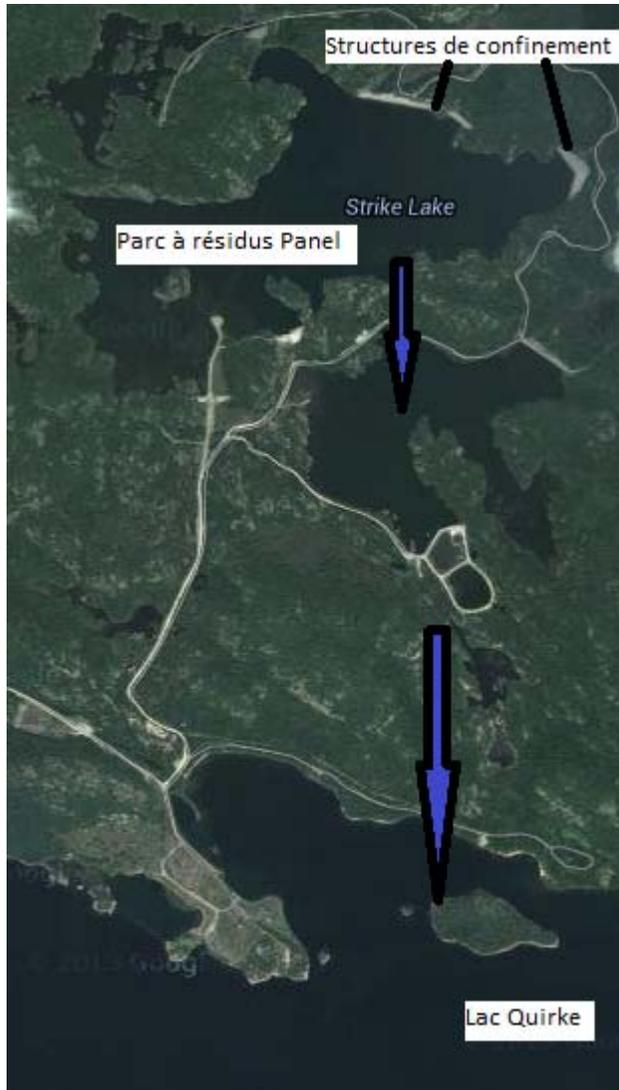
Figure A-2. Parc à résidus miniers de la mine Panel. Les flèches bleues indiquent la direction de l'écoulement des eaux de surface.
