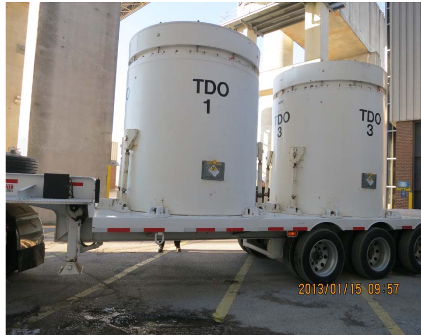
Colis de type B pour le transport d'eau lourde contenant du tritium
