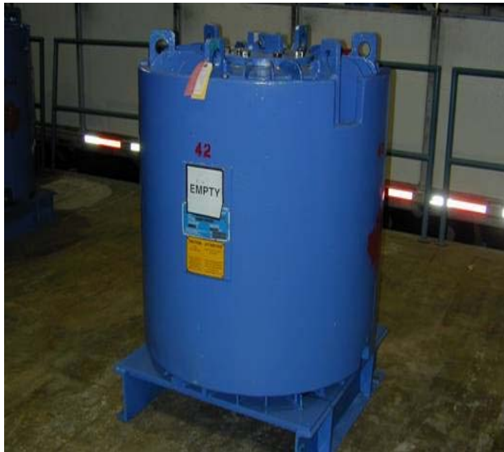
Colis de type B pour le transport du cobalt 60
