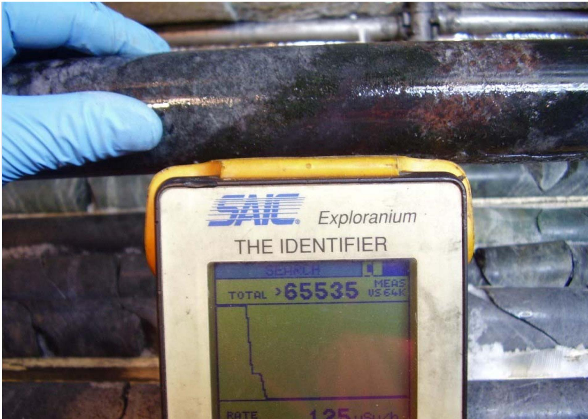
Mesure spectrométrique sur carotte de forage
