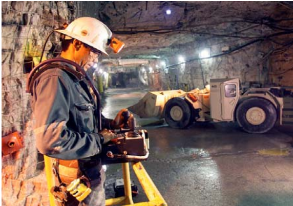
Figure 4-2 : Pelle télécommandée dans une galerie souterraine – Source : Cameco
