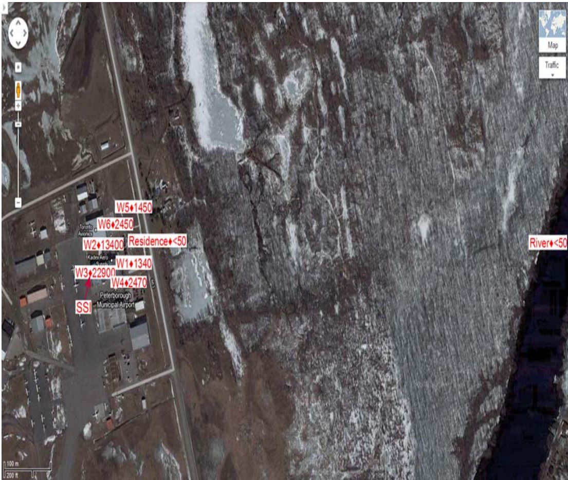
Figure 16-3 : Shield Source Incorporated – Emplacement des puits de surveillance des eaux souterraines – Source : Shield Source Incorporated
