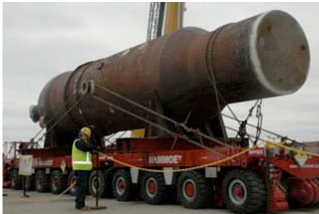
Figure H.2 — Générateur de vapeur transporté à proximité de la centrale dans le cadre des travaux de réfection
