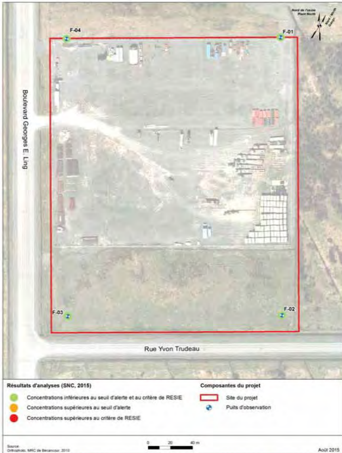
Figure 4.4 Emplacement des puits d'observation et sommaire des résultats d'analyses des eaux souterraines
