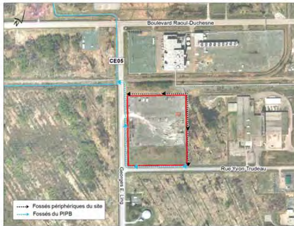
Figure 3.7 Cheminement des eaux usées et pluviales
