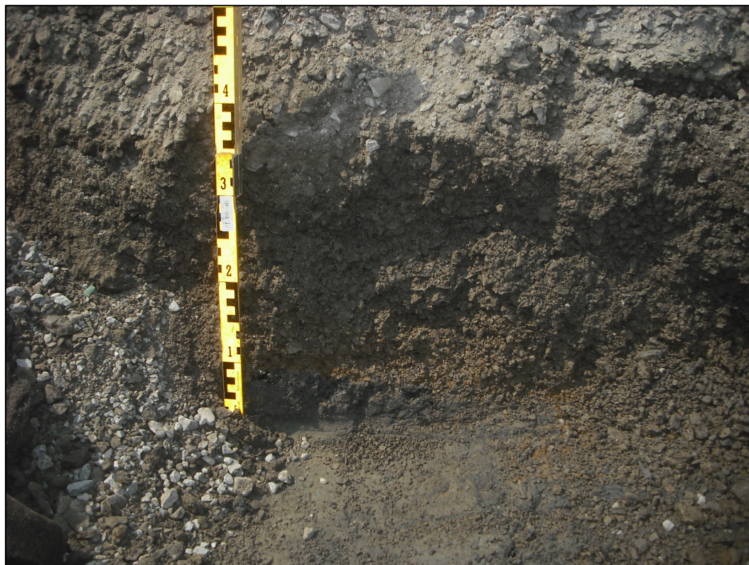
Photo 4 Contexte stratigraphique de la partie centre (remblai, sable grossier, argile)
