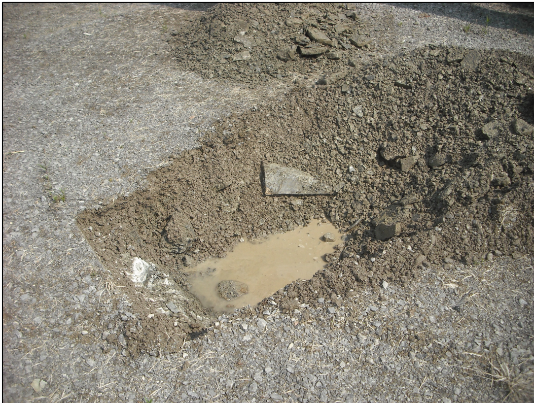
Photo 6 Contexte stratigraphique de la partie centre (remblai, eau, argile)
