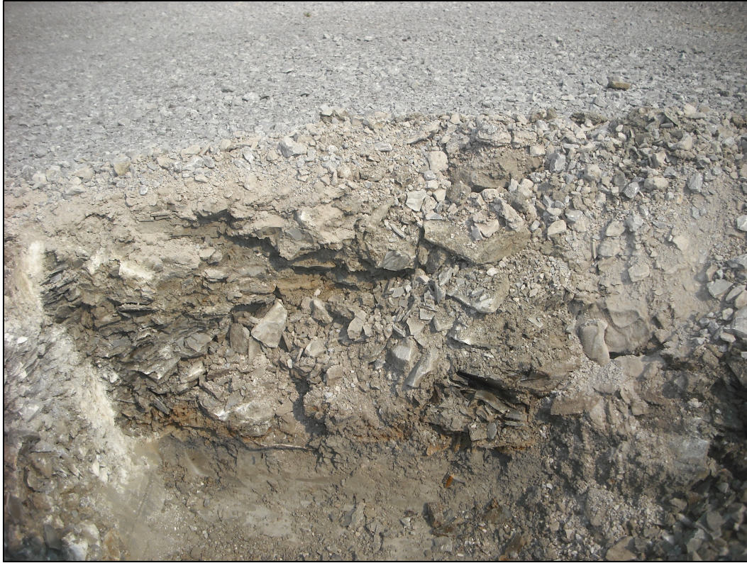
Photo 5 Contexte stratigraphique de la partie centre (remblai, argile ferrugineuse, argile)
