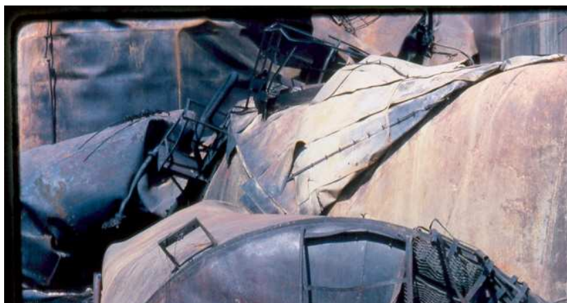
Figure 12. Bac d'hydrocarbure à la suite d'une explosion interne
