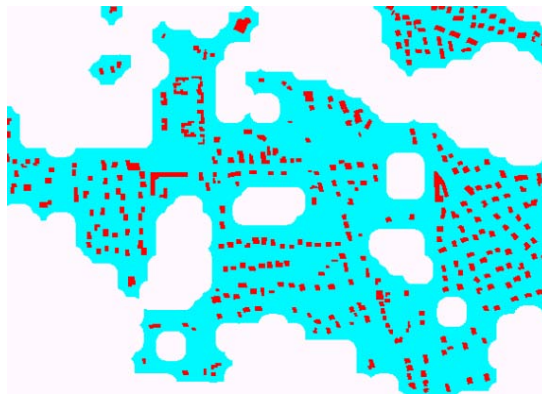
Maison individuelle en rouge et zone d'occupation des sols en bleu représentant l'ensemble homogène « habitat » (source : BDTopo®)
