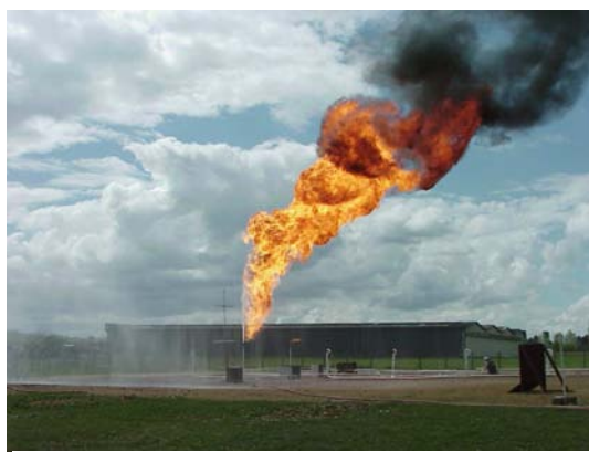
Figure 10. Feu torche dans un dépôt de gaz pétrole liquéfié
