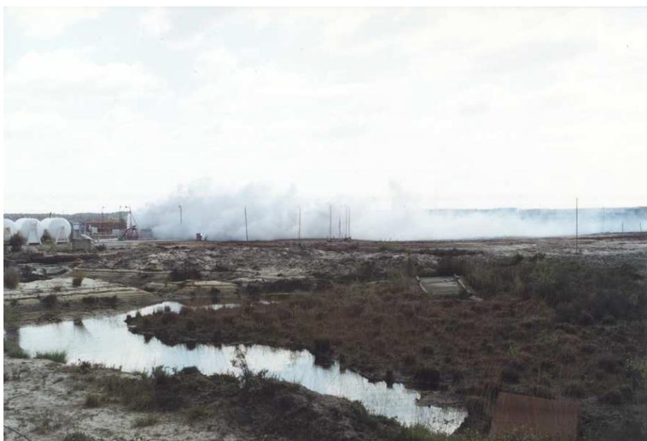
Figure 8. Essais INERIS de dispersion d'un nuage d'ammoniac à l'air libre
