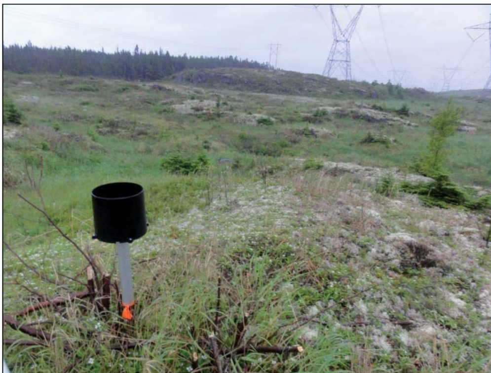
Photo 22 Pluviomètre installé sur le site d'étude (22 juin 2012).
