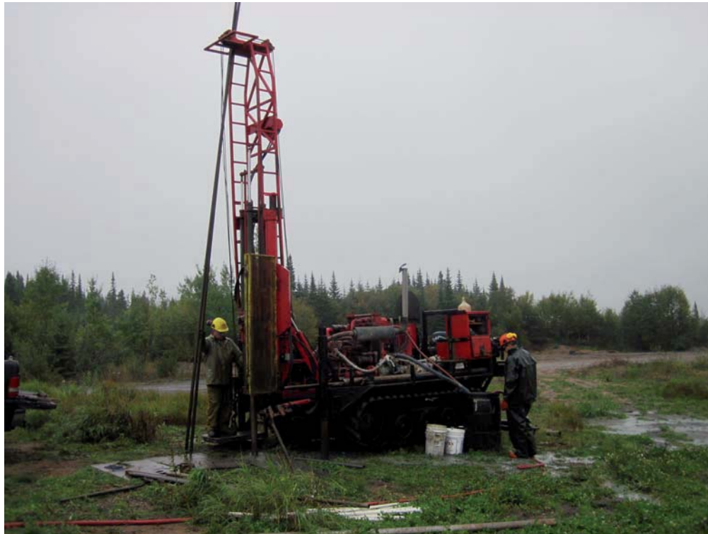
Photo 7 Forage au diamant de F-2, secteur sud de la fosse.
