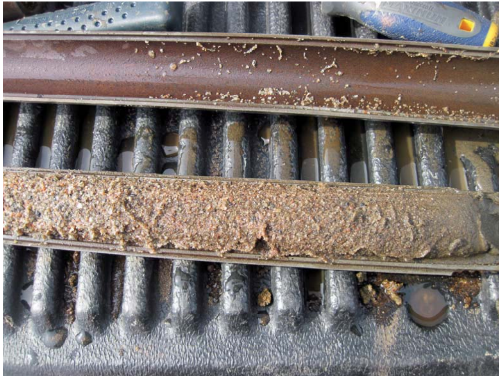
Photo 9 Échantillon de sable (F-2), secteur sud de la fosse.
