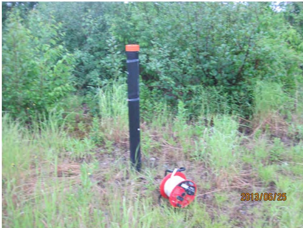
Photo 13 Installation d'un levellogger et d'un barologger au puits OW2.
