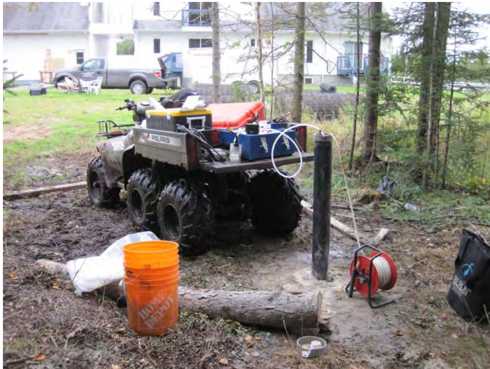
Photo 10 Micropurge, secteur sud de la fosse (PO3-R).
