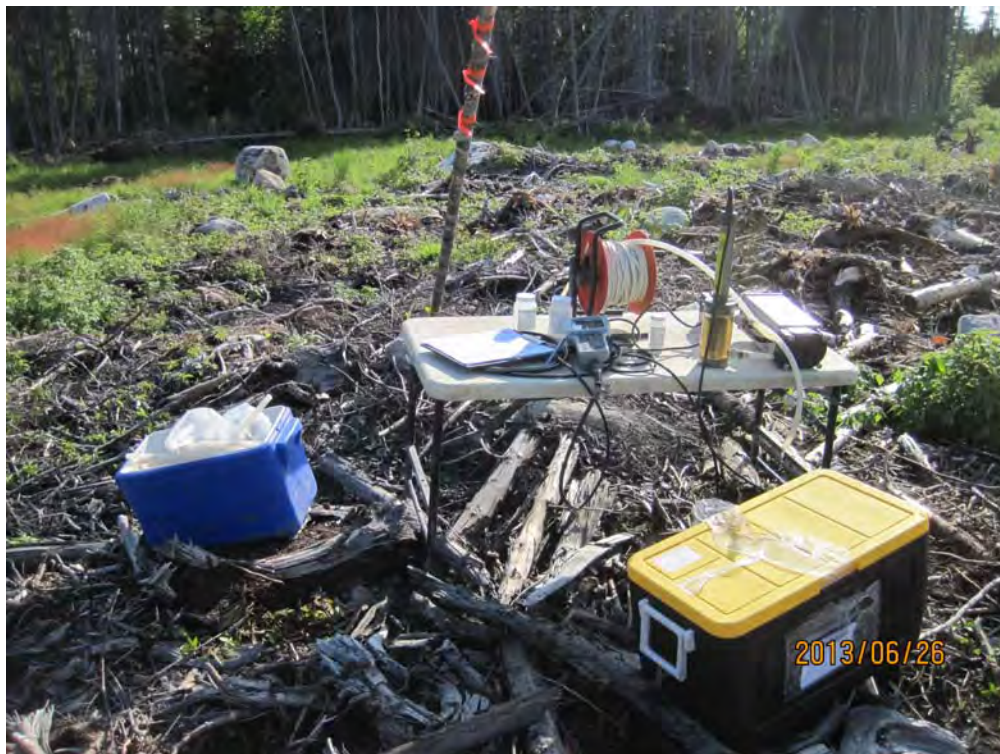
Photo 14 Échantillonnage par micropurge au puits OW3.
