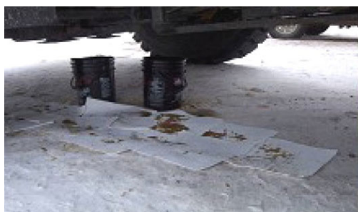
Photo I.2 : Feuilles absorbantes pour récupérer une fuite d'huile
