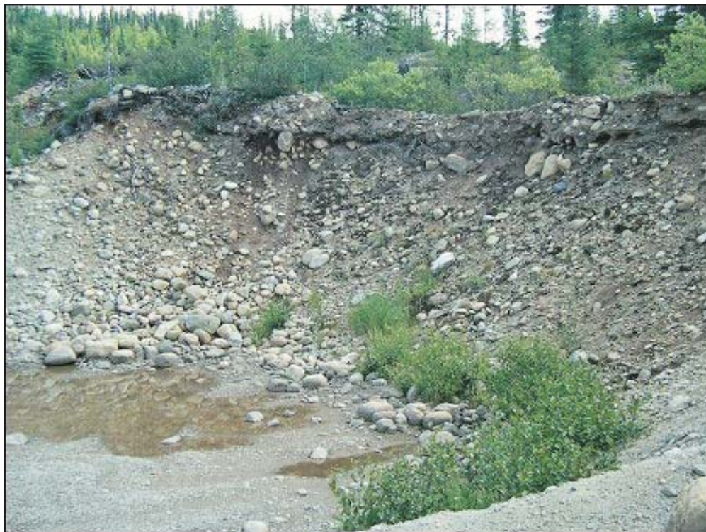
Photo 16. Coupe verticale du sol montrant la présence et l'abondance des blocs de pierre
