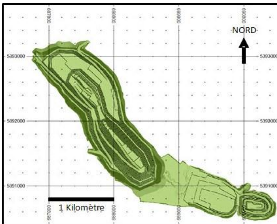
Figure 16.15 : Développement de la mine - Fin de l'an 6
