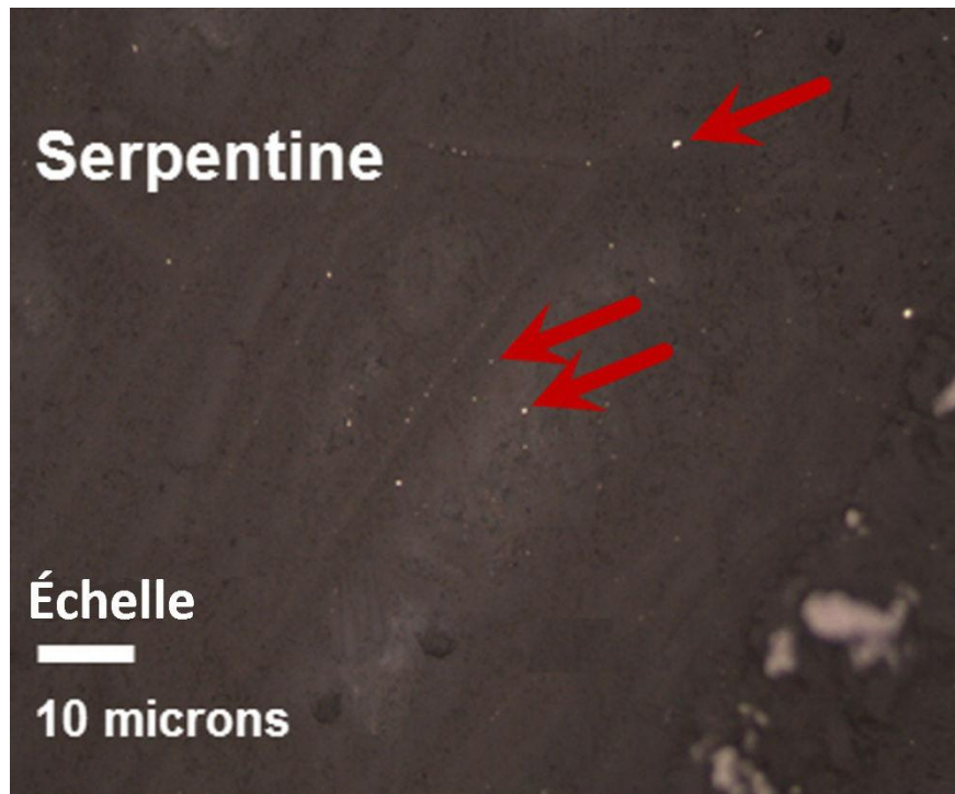
Figure 7.10 : Image BSE de fines inclusions de nickel dans une matrice de serpentine
